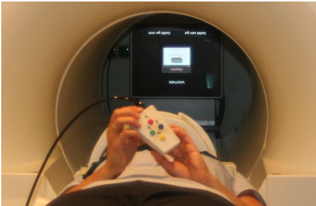
Abbildung 11: Handtaster mit 4 Bewertungsmöglichkeiten im Vordergrund des Bildes, LCD Monitor mit den vorbereiteten „am Kopf stehenden“ Bildsequenzen, die über einen Spiegel auf den Monitor des MRI's projiziert wurden und vom Probanden daher wieder regulär zu sehen waren, im Hintergrund
